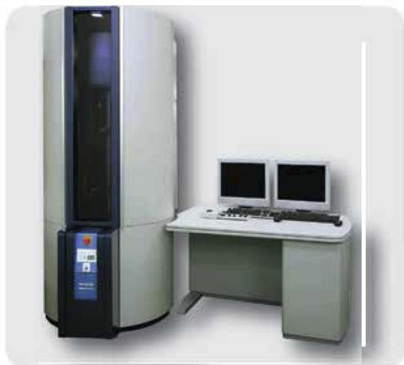
Сканирующе-просвечивающие микроскопы предназначены для работы с тонкими образцами, не уступая в возможностях традиционному просвечивающему микроскопу. Сам принцип формирования изображения позволяет выводить изображение одновременно с трех детекторов BF, DF и SE. Любая модификация доступна на выбор с катодом Шоттки или с холодным полевым катодом.
