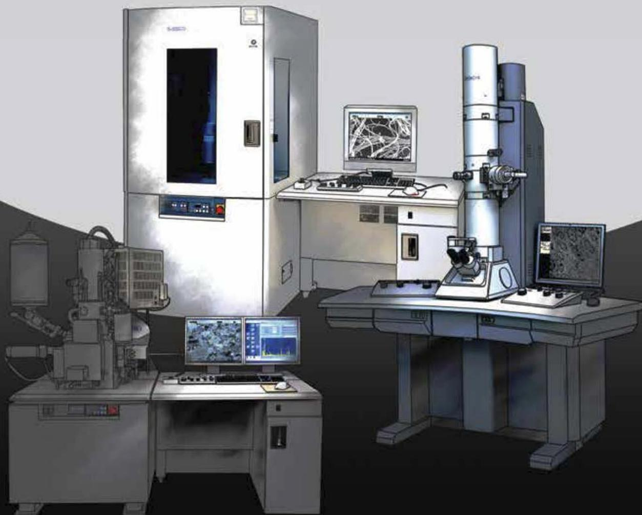
Микроскоп SU9000 с холодным вольфрамовым катодом разрабатывался для достижения наивысшего разрешения при работе с нанобъектами, и выполнен в «in-lens» дизайне. Электронная оптика SU9000 позволяет получать изображения морфологии поверхности образцов различных материалов, с детализацией вплоть до атомного или молекулярного уровня, что далеко превосходит по возможностям любой сканирующий микроскоп.
