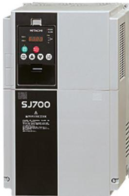
Преобразователи частоты SJ700 имеют усовершенствованную функцию бессенсорного векторного контроля, которая делает возможным пусковой момент 200% при 0,3 Гц. Сочетание высокой скорости выполнения операций, усовершенствованного регулятора тока и функции подавления перегрузки по току и напряжению обеспечивает предотвращение отключения инвертора во время разгона и замедления.
